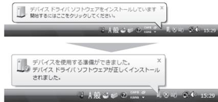
認識が完了したら、付属のCD-ROMでドライバをインストールします。
