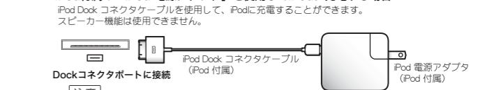
注意 iPod付属のiPod USB電源アダプタと付属のACアダプタを併用した場合、ACアダプタからの電源が優先されるため、スピーカー機能を使用できるようになります。
