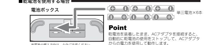
注意 乾電池を装着したまま、ACアダプタを接続すると、自動的に乾電池の使用をストップして、ACアダプタからの電力を使用して動作します。
