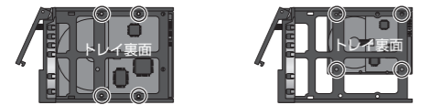
3.5 インチディスクを固定する場合のネジ穴 2.5 インチディスクを固定する場合のネジ穴
