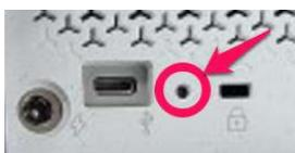
3. ペーパークリップでリストアボタンを押したまま、電源を再投入してシステムの電源を入れます。
